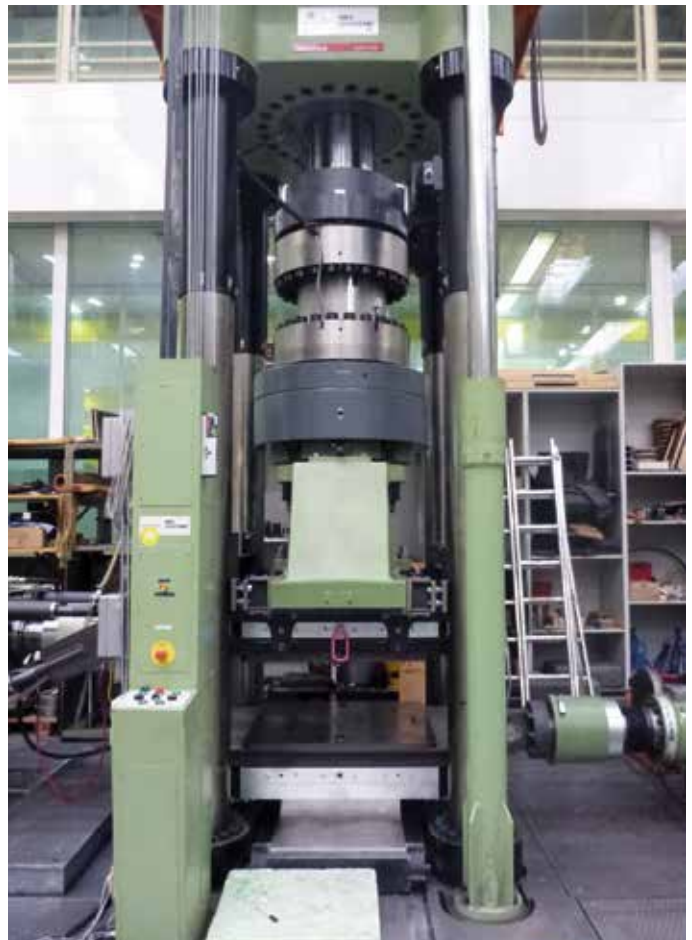
Test press 10 MN Universität der Bundeswehr München in Munich / Germany
